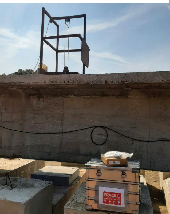
Impulso dinamico tramite maglio
