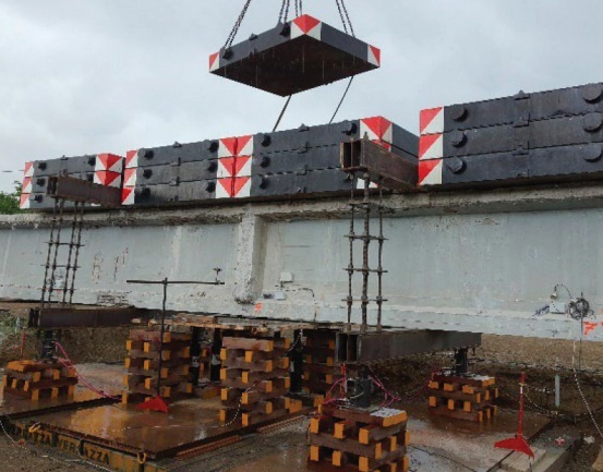
Trave in CA ordinario e strumenti di prova (accelerometri e inclinometri)
