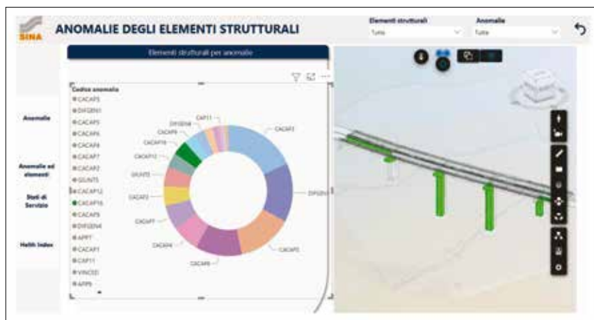
6. Il mock-up delle dashboard del progetto pilota - la mappatura delle tipologie dei difetti da Linee Guida MIT e l'identificazione degli elementi sul modello BIM affetti da tale anomalia. Si tratta di report dinamici che variano in modo bidirezionale tra modelli e dashboard
