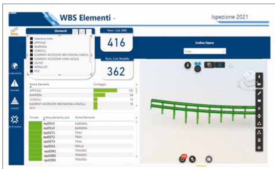
3. Dashboard "WBS" con tutti gli elementi selezionati sviluppata nello strumento di Business Intelligence e integrata con la visualizzazione del modello BIM
