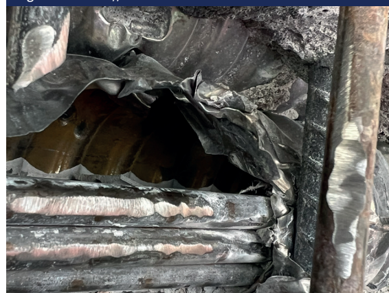
Fig. 11. Saggio diretto su cavo di post-tensione
