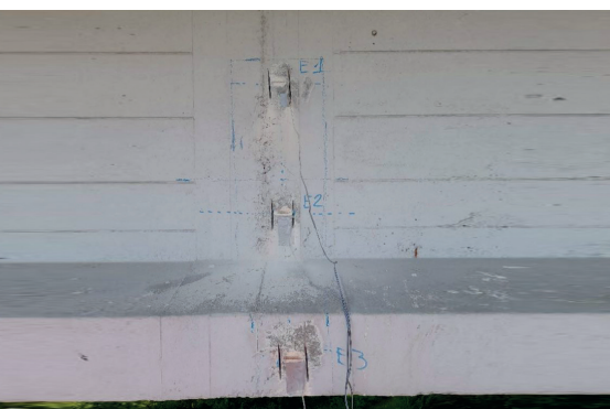
14. Prova di rilascio tensionale sul cls e diagramma di acquisizione delle deformazioni nel tempo
