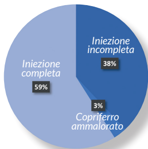
Fig. 9. Stato di iniezione in guaine in zone rilevate potenzialmente diftose dal tomografo
