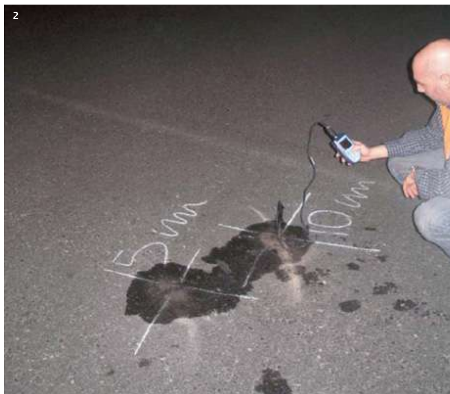
2 - Misura della temperatura della pavimentazione 3 - Rilievi deflettometrici con HWD
