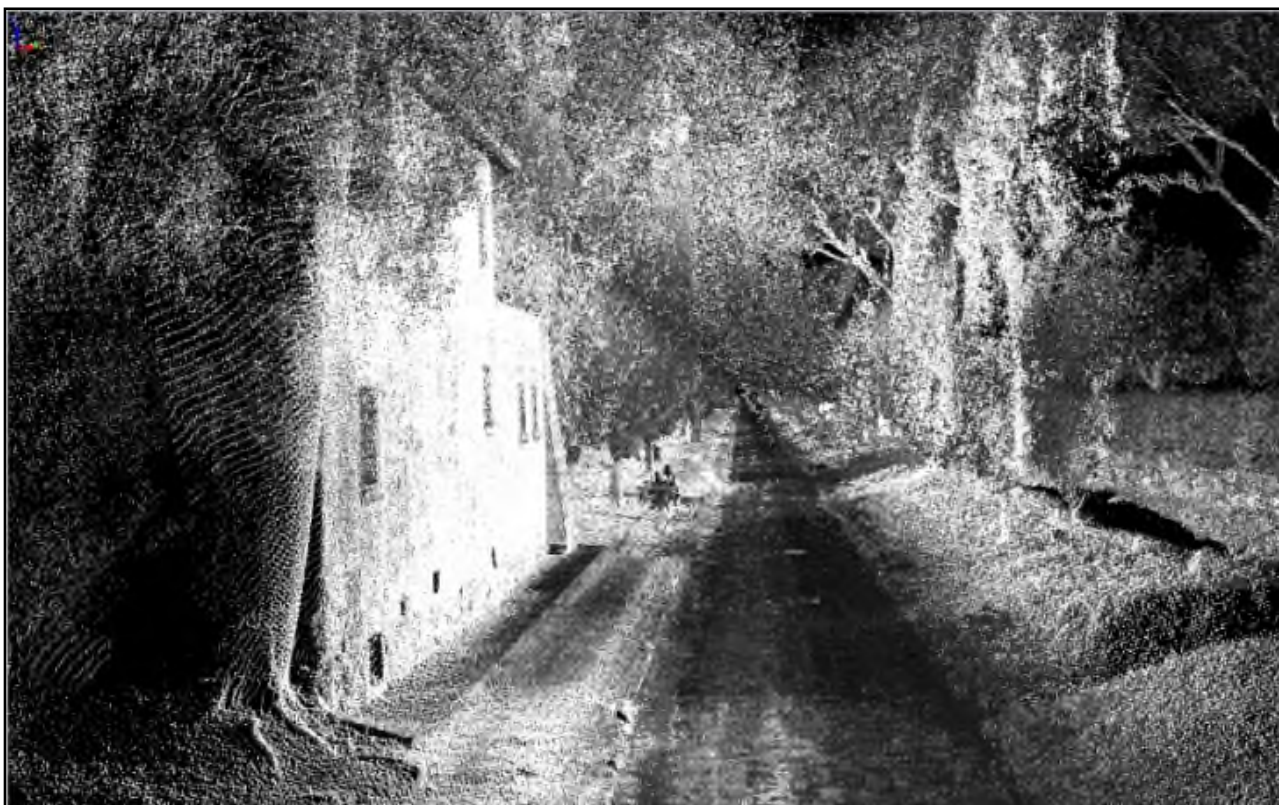
Figura 5 - Nuvola di punti acquisita dal Laser Mobile Mapper
